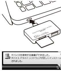
USBハブを経由でパソコンに接続する場合は、必ずセルフパワー mode で使用して、USBポートに電源が供給できる状態にしてください。
