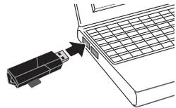
**注意** USBハブを経由してパソコンに接続する場合は、必ずセルフパワーモードで使用して、USBポートに電源が供給できる状態にしてください。ACアダプタで電源供給できないUSBハブは使用できません。
