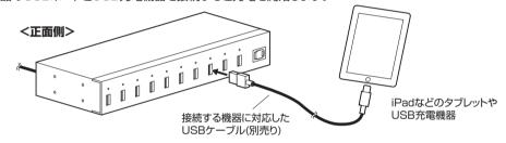
●充電が完了すると、LEDが緑色になりますので本製品と機器からUSBケーブルを取外します。 ※機器によっては充電完了後にLED緑色に切り替わらない場合があります。
