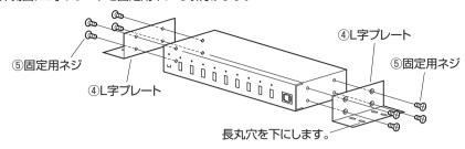
❷弊社製の対応するキャビネット、ラックなどに取付けます。 ※対応するキャビネット、ラックには取付け用のネジ穴があります。
