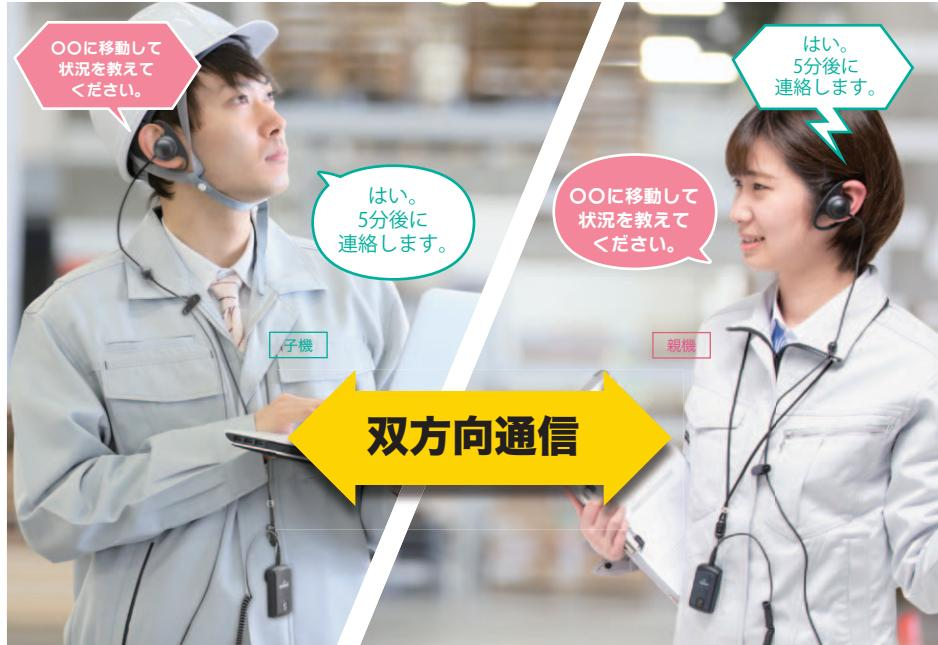
ワイヤレスガイドシステム(無線ガイドマイク)は、ワイヤレスで音声を多人数に一斉送信できる機器。双方で通信できるので工場見学や工場内でのコミュニケーションに最適。
