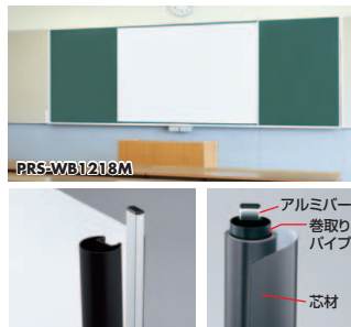
巻取りパイプのくぼみにアルミバーをセットし、巻取りパイプを芯材とするとスムーズに巻取れる。裏面はやわらかく薄い軽量マグネットシート素材。
