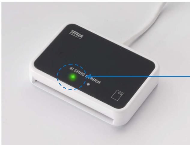
ゆっくりと点滅(2秒間に約1回点滅)していれば、インストールの完了です。
