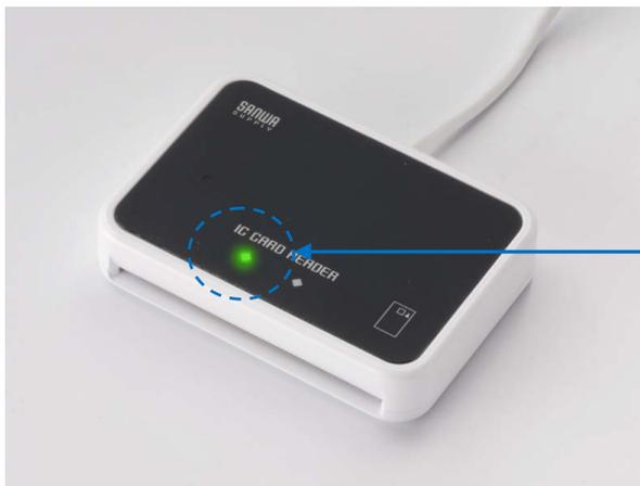
ゆっくりと点滅(2秒間に約1回点滅)していれば、インストールの完了です。
