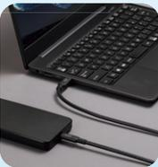
USB4の電力供給は7.5W以上かつUSB PD対応が必須。USB PD EPR1に対応している場合は最大で**240W(48V/5A)**。ノートパソコンなどの消費電力の大きいデバイスの充電もUSB4ひとつで**高速充電**が可能になりました。
