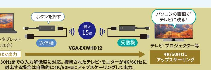
\*接続されたテレビ・ディスプレイのEDID情報を判断し、自動的に適切な解像度にアップスケール/ダウンスケールされます。
