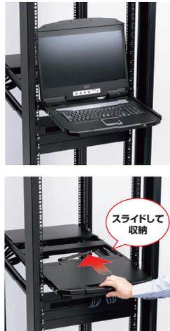
サーバー管理に必要なモニター、キーボード、マウスのコンソール類を省スペースに設置・収納できるため、作業効率が格段にアップ。
