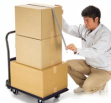
先端のフックを荷物に巻き、台車前側の縁に引っ掛ける。
